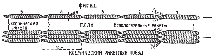
Реактивный поезд для полета в мировом пространстве, предложенный К. Э. Циолковским, 1929 год
